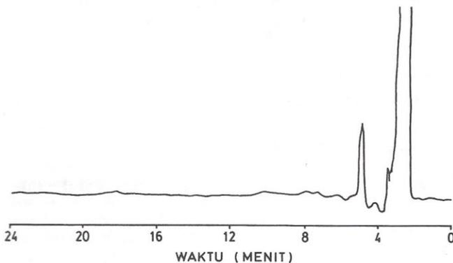
Gambar 5. Kromatogram dari contoh udang yang mengalami perlakuan pendahuluan menggunakan kolom SPE. Kolom:  $\mu$  Bondapak C<sub>18</sub>, Detektor: UV. Eluen: metanol-asetonitril-0,01 m asam oksalat (1:1,5:7). Kecepatan aliran: 1 ml/mnt dan kecepatan kertas 0,5 cm/mnt.
