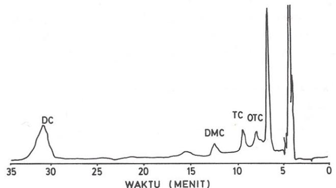
Gambar 7. Kromatogram contoh udang yang ditambah standar, dan dilewatkan ke kolom SPE. Kolom:  $\mu$  Bondapak C<sub>18</sub>, Detektor: UV. Eluen: metanol-asetonitril-0,01M asam oksalat (1:1,5:7). Kecepatan aliran: 1ml/menit dan kecepatan kertas 0,5 cm/mnt.
