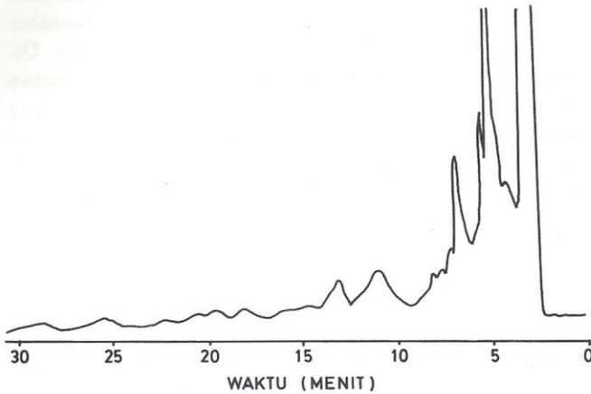
Gambar 4. Kromatogram dari contoh udang yang tidak dilewatkan ke dalam kolom SPE. Kolom:  $\mu$  Bondapak C<sub>18</sub>, detektor: UV. Eluen: metanol-asetonitril-0,01 M asam oksalat (1:1,5:7). Kecepatan aliran 1 ml/menit dan kecepatan kertas 0,5 cm/mnt.
