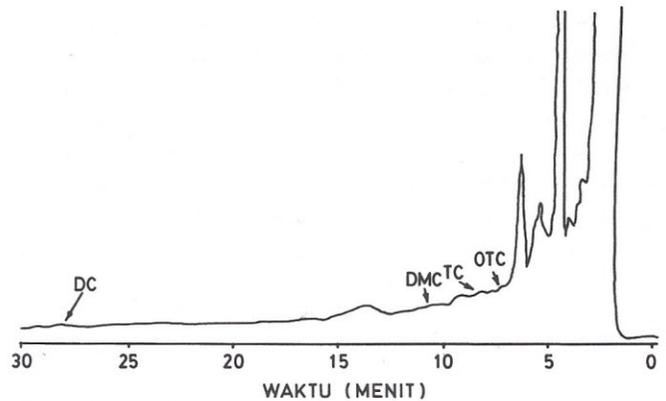
Gambar 6. Kromatogram contoh udang yang ditambah standar. Kolom:  $\mu$  Bondapak C<sub>18</sub>, Detektor: UV. Eluen: metanol-asetonitril-0,01M asam oksalat (1:1,5:7). Kecepatan aliran: 1 ml/menit kecepatan kertas 0,5 cm/mnt.
